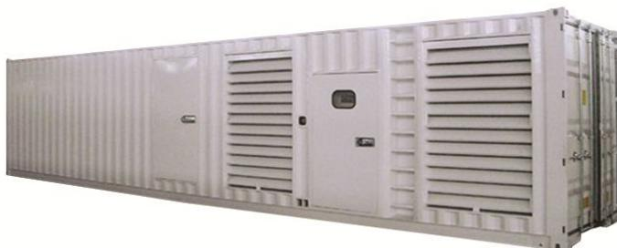
Container insonorizzato realizzato secondo dimensioni ISO standard, completo di marmitta residenziale. Rumorosità residua 70dB + - 3 a 7 metri. Le pareti sono in lamiera grecata, insonorizzate con pannelli fonoassorbenti in classe 0 con protezione di lamiera forata verniciata. Completati di porte per l'ispezione per manutenzioni ordinarie/straordinarie di cui una porta dotata di oblò e maniglione antipanico omologato. Il container viene sottoposto a verniciatura esterna marinizzata.
