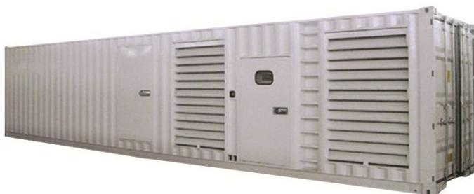
Container insonorizzato realizzato secondo dimensioni ISO standard, completo di marmitta residenziale. Rumorosità residua 70dB + - 3 a 7 metri. Le pareti sono in lamiera grecata, insonorizzate con pannelli fonoassorbenti in classe 0 con protezione di lamiera forata verniciata. Completati di porte per l'ispezione per manutenzioni ordinarie/straordinarie di cui una porta dotata di oblò e maniglia antipanico omologato. Il container viene sottoposto a verniciatura esterna marinizzata.
